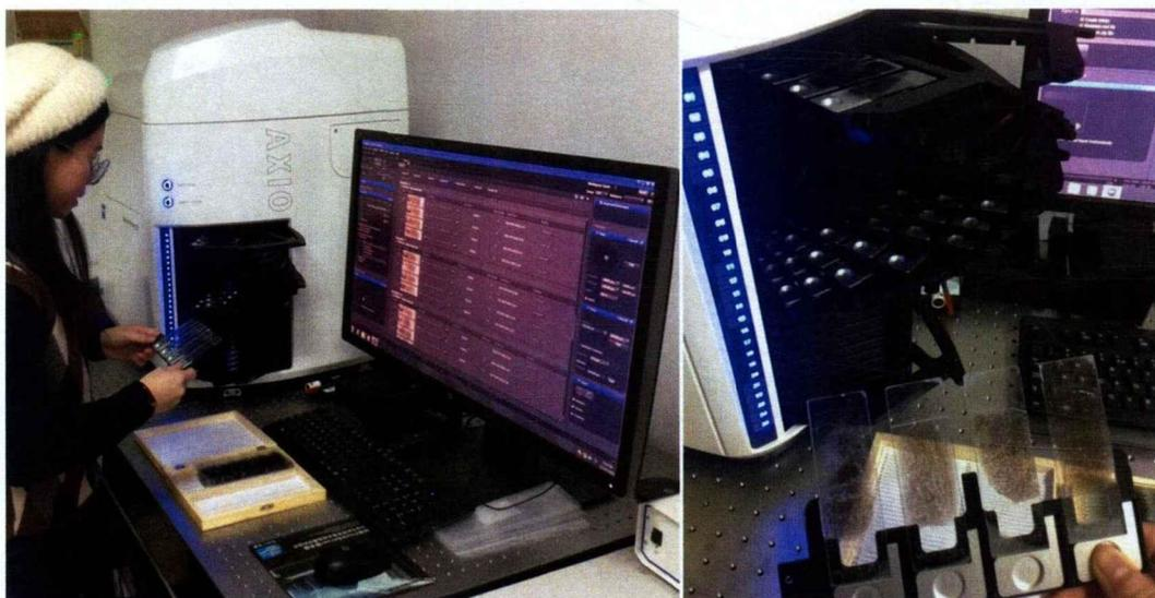
图 3-1-1 全自动数字玻片扫描仪及标准玻片样品夹
